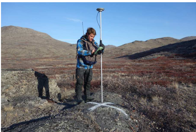
Indmåling af paspunkt til fotoflyvning. Foto: AWH.
