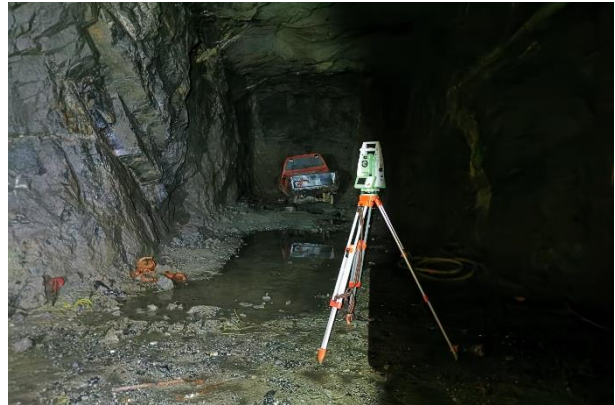
Totalstation opstillet i minegang. Foto: Mikkel Chr. Mikkelsen.
