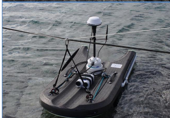
Vandføringsmåling med ny ADCP med GPS, for hurtigere måling og høj kvalitet
